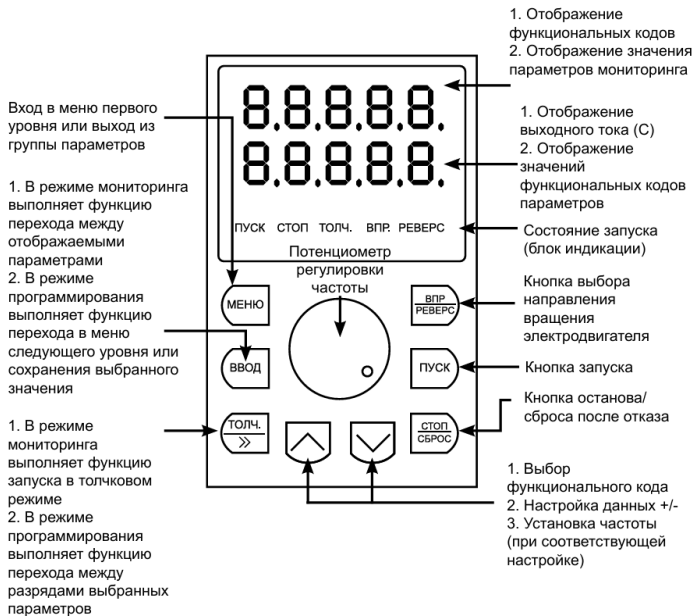
Рисунок 6 – Описание панели управления LCI-KP
