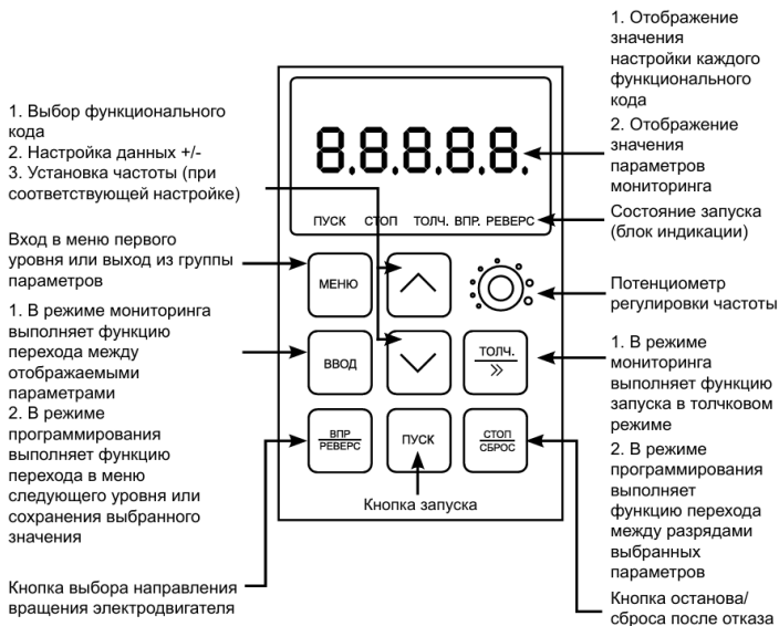
Рисунок 5 – Описание панели управления LCI-KP-S
